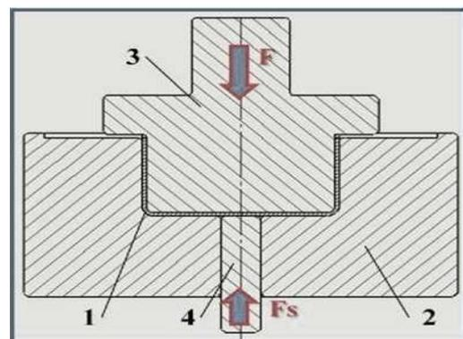
Fig. 1. U-bending mold [1, 2].
